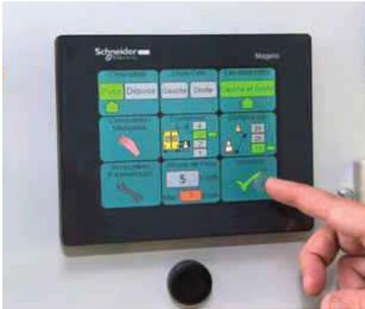
L'IHM permet à l'opérateur de régler très simplement le MarkWay pour un balisage à gauche ou à droite ou encore des deux côtés du véhicule en même temps.
