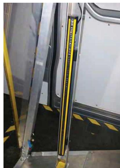
*Ci-dessus : La sécurité de l'opérateur est assurée par un barrage immatériel de Tec4 Prime et un scrutateur laser S300. Ils stoppent le MarkWay en cas d'intrusion du bras dans la machine par l'avant ou les côtés.*
