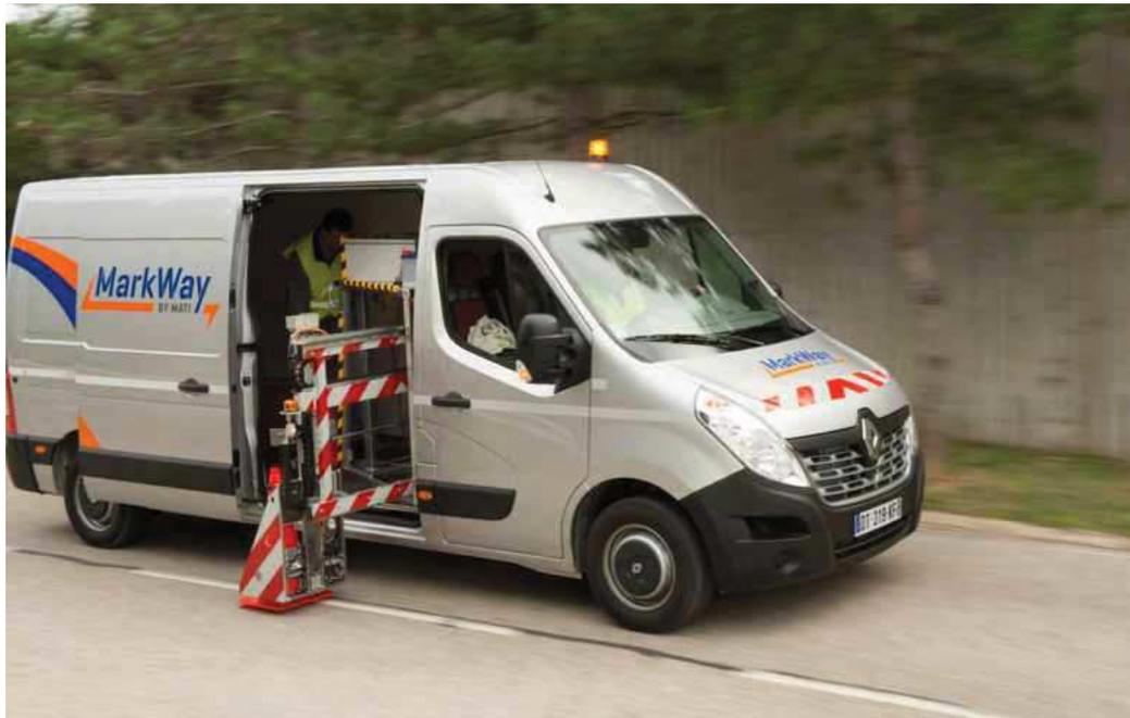
Le MarkWay est conçu pour la pose et la dépose de cônes signalisation
