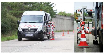
Système automatisé de pose et de dépose de cônes de signalisation. L'agent d'autoroute ne se penche plus hors du véhicule d'intervention pour baliser la route
